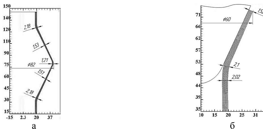
Рис. 4. Форма и размеры в миллиметрах сформированных заготовок: а – после раздачи с действием давления жидкости; б – после традиционной открытой раздачи
